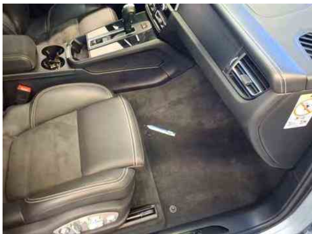
Beschädigung #12: Verkleidungen/Abdeckungen: Teppichboden vorn rechts - Brandloch
