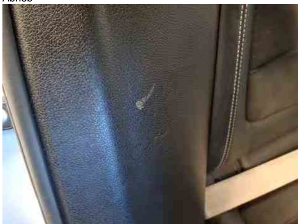
Beschädigung #7: Seitenwand rechts: Einstieg (Innenverkleidung) - Kratzer
