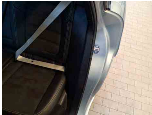
Beschädigung #6: Seitenwand links: Einstieg (Verkleidung) - Abrieb
