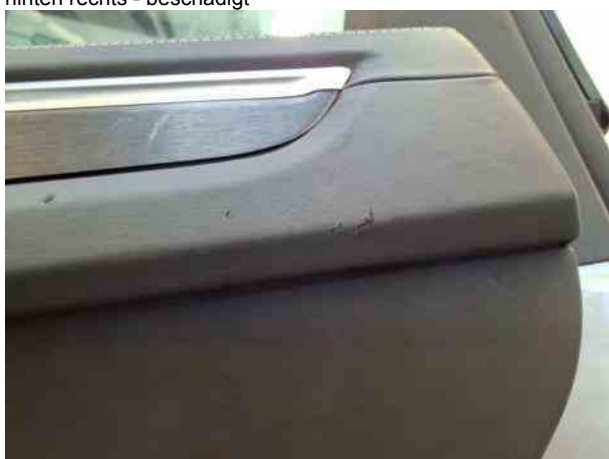
Beschädigung #15: Verkleidungen/Abdeckungen: Türverkleidung hinten rechts - beschädigt
