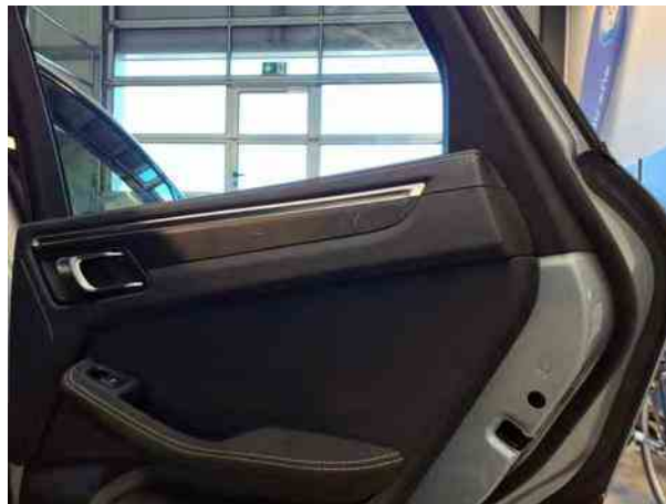
Beschädigung #15: Verkleidungen/Abdeckungen: Türverkleidung hinten rechts - beschädigt
