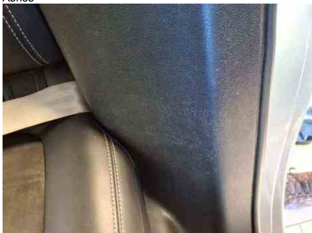
Beschädigung #6: Seitenwand links: Einstieg (Verkleidung) - Abrieb
