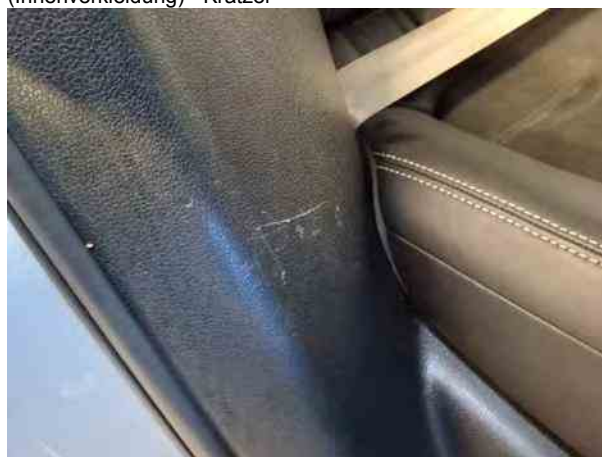
Beschädigung #7: Seitenwand rechts: Einstieg (Innenverkleidung) - Kratzer
