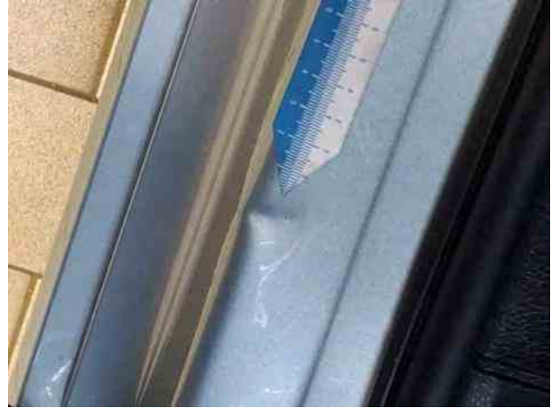
Beschädigung #8: Seitenwand rechts: Einstieg - Delle / Lackschaden
