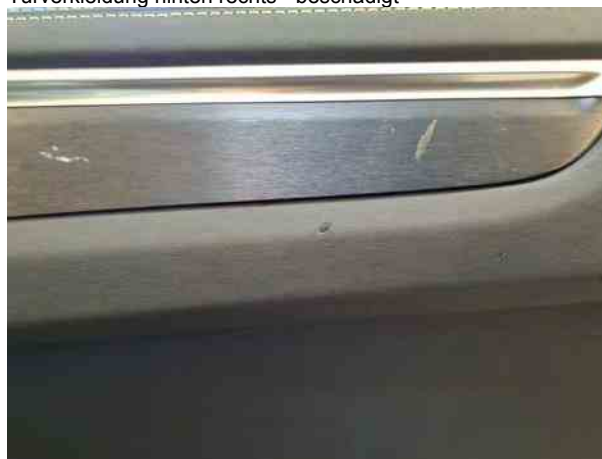
Beschädigung #15: Verkleidungen/Abdeckungen: Türverkleidung hinten rechts - beschädigt
