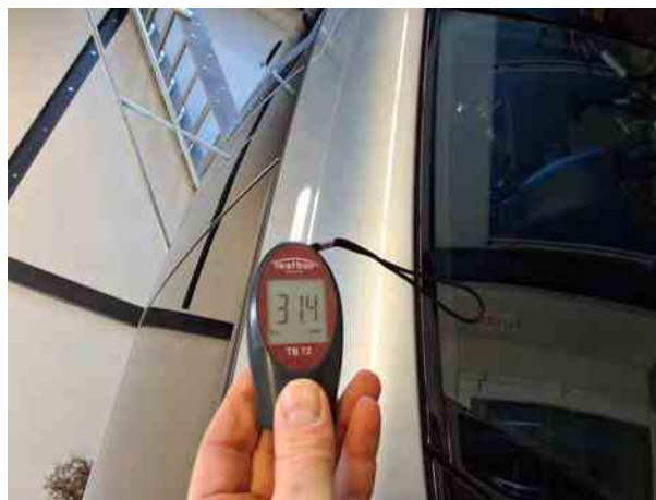
Nachlackierung 2: Dachholm rechts
