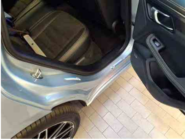
Beschädigung #8: Seitenwand rechts: Einstieg - Delle / Lackschaden
