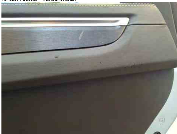
Beschädigung #15: Verkleidungen/Abdeckungen: Türverkleidung hinten rechts - beschädigt
